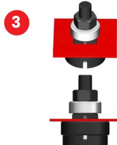
Coloque la chapa entre el macho y la hembra. Si el perforador y la chapa están bien engrasados el corte será mucho más fácil. / *Place the sheet between the male and the die. If the punch and the plate are well greased the cut will be much easier.*
